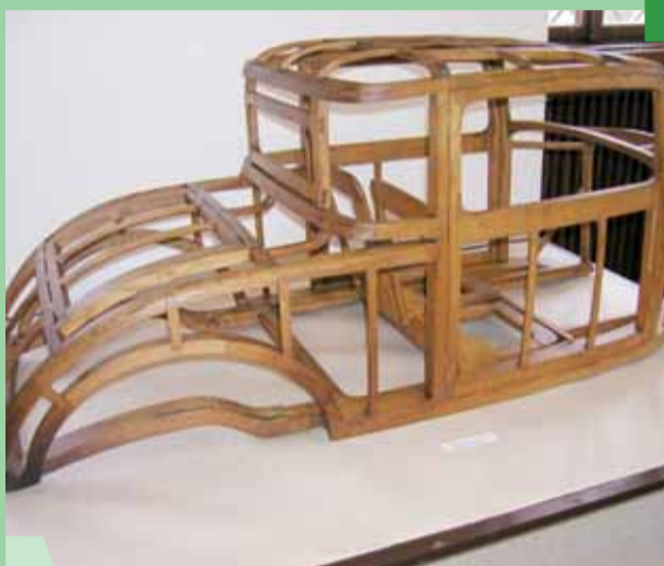
Model drewnianego szkieletu samochodu. Na zdjęciu zabytkowy eksponat O. Prokopa.
